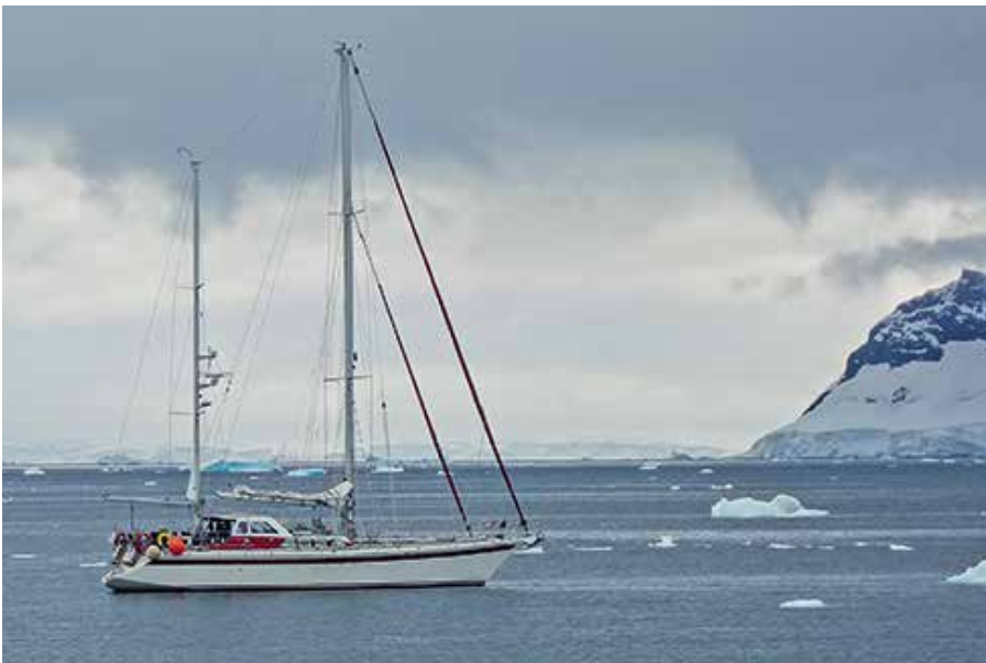
Die »Santa Maria Australis« wurde 1998 in Gdansk in Polen gebaut. Sie ist 20,2 Meter lang, 5,5 Meter breit und hat einen Tiefgang von 2,3 Meter. Ihre Segelfläche misst 220 Quadratmeter. Das Schiff bewältigte von 2006 bis heute 40 Expeditionen in die Antarktis, 2011 gelang ihm die Durchsegelung der Nordwestpassage. Vier Kabinen bieten Platz für bis zu zwölf Personen.
