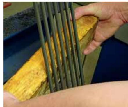
*Voruntersuchung bei möglichen Drahtbrüchen. Die Brüche haken im Holz ein. Der Prüfer merkt es am Ton und einem Ruck in der Hand. Darauf folgt die Hauptuntersuchung im Schacht.*
