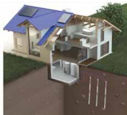
Bild 1: Mit Hilfe von Erdwärmesonden wird dem Erdbereich bis 120 Meter Tiefe Wärme entzogen.
