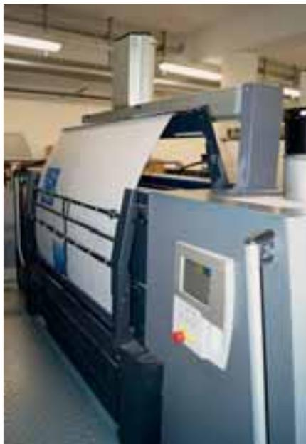
UV-Licht trocknet die bedruckten Papiere in Millisekunden, sodass pro Stunde 3300 Blatt Papier bedruckt werden können.
